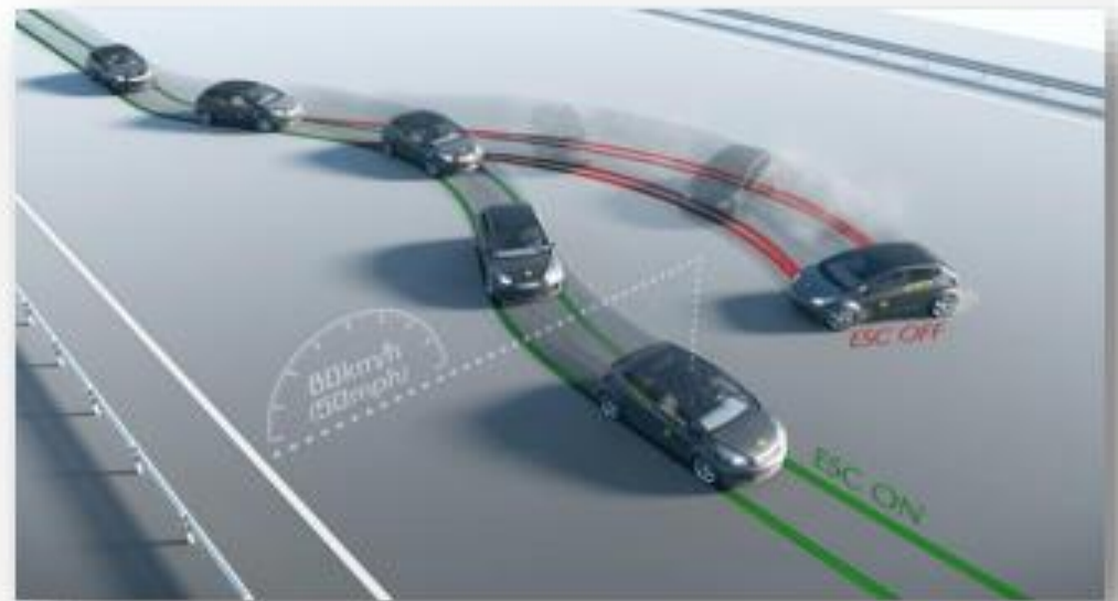
شکل ۹: تاثیر فناوری پایداری الکترونیکی در افزایش پایداری خودرو
