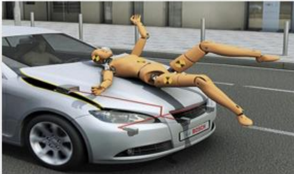
شکل ۱۳: سیستم حفاظت از عابر پیاده به هنگام تصادف
