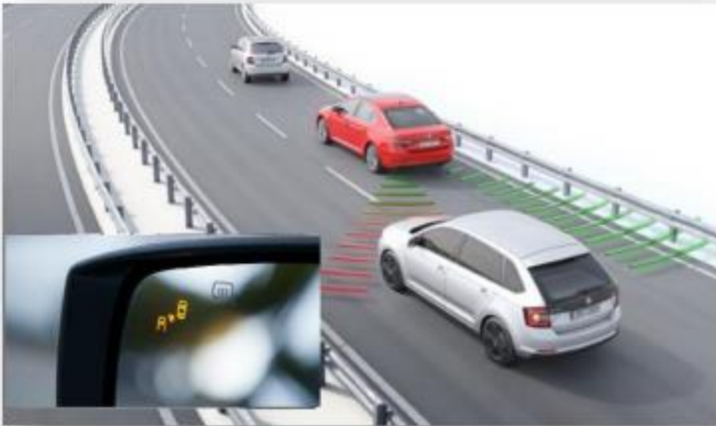
شکل ۱۰: نحوه عملکرد سیستم پایش نقاط کور خودرو
