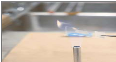
شکل شماره ۱۳. فیکس کردن گستره با استفاده از شعله
