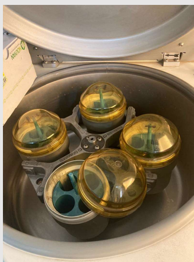
شکل شماره ۱۲. سانتریفیوژ ایمن (باکت‌های درپوش‌دار)
