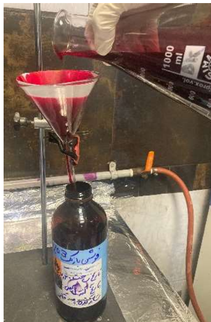
شکل شماره ۳۱. فیلتر کردن محلول فوشین برای حذف رسوبات
